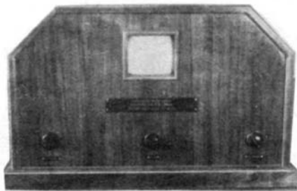
Mit Braunscher Röhre arbeitet dieser Fernseh-Empfänger von M. v. Ardenne.
